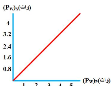
8- لدينا محول. يوضح التمثيل البياني الآتي العلاقة بين قدرة الدخل  $P$  ( $P_W$ )<sub>P</sub> وقدرة الخرج  $S$  ( $P_W$ )<sub>S</sub> الجهد المطبق على الملف الابتدائي يساوي 15V، والجهد المستحب عبر الملف الثانوي يساوي 72V اذا كانت شدة التيار المار في الملف الثانوي تساوي 2A فإن شدة التيار المار في الملف الابتدائي تساوي .....
