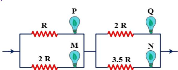
7- أربعة مصابيح متماثلة  $N, M, P, Q$  ، مقاومة فتيلة كل منها  $R$  ، وصلت مع عدة مقاومات كما موضح بالشكل المقابل، فإن شدة الإضاءة تكون متماثلة
