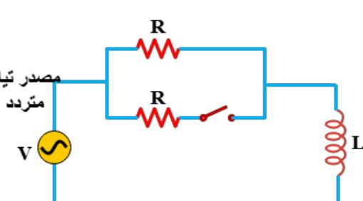
16- في الدائرة الكهربية الموضحة بالشكل المقابل عند غلق المفتاح (K)، فإن زاوية الطور بين الجهد الكلي (V) والتيار (I).....
